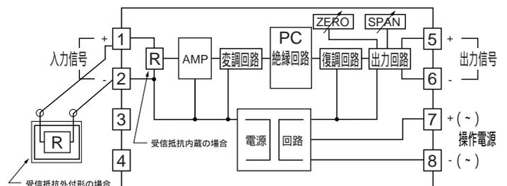
外付の受信抵抗器 : 受信抵抗を外付にした場合、メンテナンス等によりソケットから本体が離れた場合でも入力信号ラインは、切断されずすみずみ。
